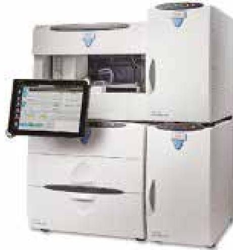
El proceso de análisis inició con la preparación de las muestras de acuerdo con lo que marcan los procedimientos desarrollados por los laboratorios del INECC, en los cuales se indica que la muestra es extraída y posteriormente analizada por cromatografía iónica con supresión química (Figura 38)
